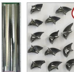
Хорошее качество поверхности и контроль стружкообразования
