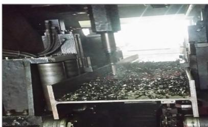
**Режимы резания**  $v_c$  (м/мин) = 70,  $f_n$  (мм/об) = 0.23,  $a_p$  (мм) = 30, с СОЖ
