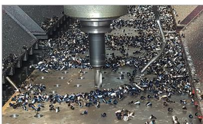
**Режимы резания**  $v_c$  (м/мин) = 80,  $f_n$  (мм/об) = 0.27,  $a_p$  (мм) = 25, с СОЖ
