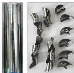
» Хорошее качество поверхности за счёт стабильного стружкообразования и эффективного отвода стружки
